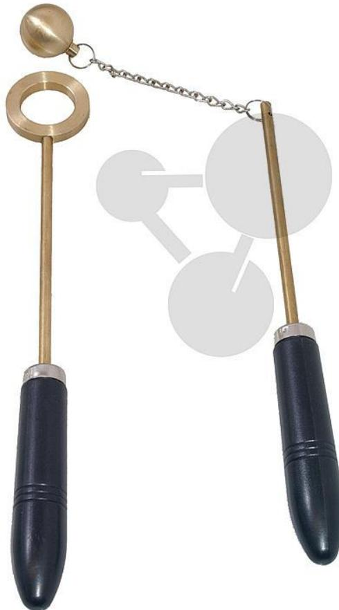
L'anneau de S'Gravesande est une expérience de physique des matériaux et de thermodynamique conçue par le physicien néerlandais du même nom. Cette expérience illustre le phénomène de dilatation thermique en observant le passage d'une sphère de métal au travers d'un anneau.
